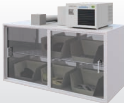
エージング槽（プラスチック・ゴム）
