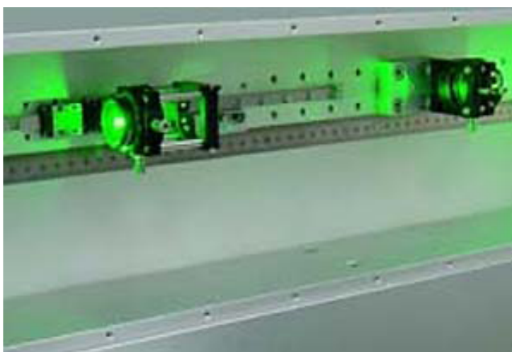
レーザー光学系全体をパージする
