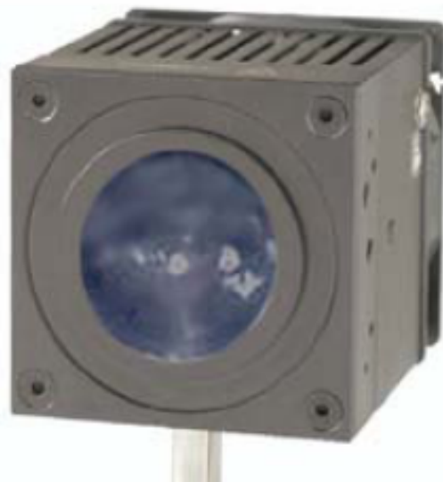
レーザーによりヘッドの受光面に ところどころダメージがある
