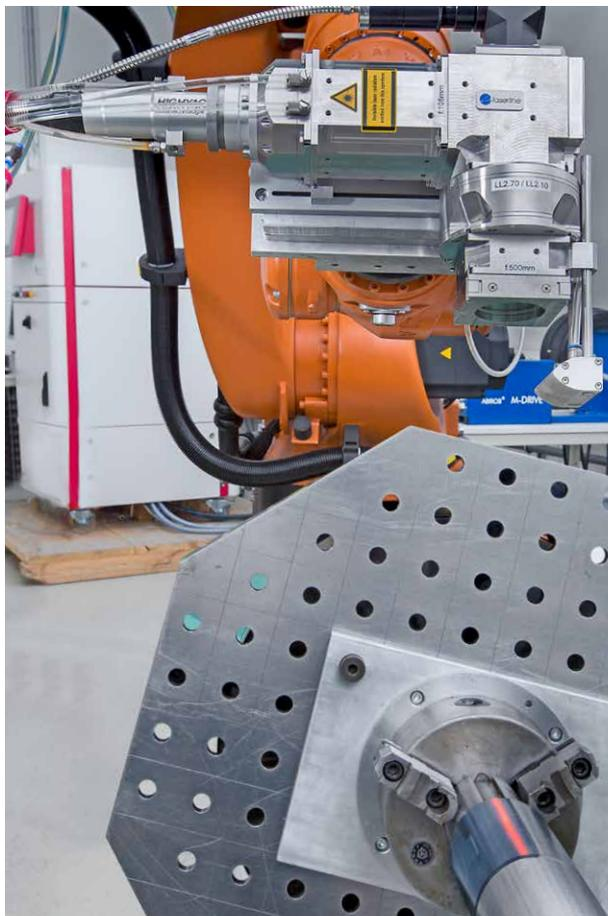
Die Optik kann um weitere Zusatzkomponenten, wie z. B. Beschichtungsdüsen (Pos. 22 + 23) oder Drahtzuführereinheiten ergänzt werden. Mögliche Erweiterungen zur Erfüllung der Anforderungen an einen produktions sicheren Prozess sind vielfältig. Die Integration von Auskoppelmodulen ermöglicht unter anderem den Einsatz von Pyrometern (Pos. 8 + 9) zur Messung der Temperaturstrahlung oder von CMOS-Kamerasystemen (Pos. 10) zur Prozessbeobachtung.
